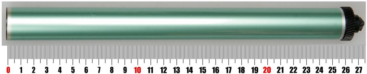
3. Покрытие на барабане прозрачное (свет отражается от алюминиевой поверхности барабана), это покрытие имеет при обычном освещении зеленые оттенки. Общая длина барабана 273 мм.
